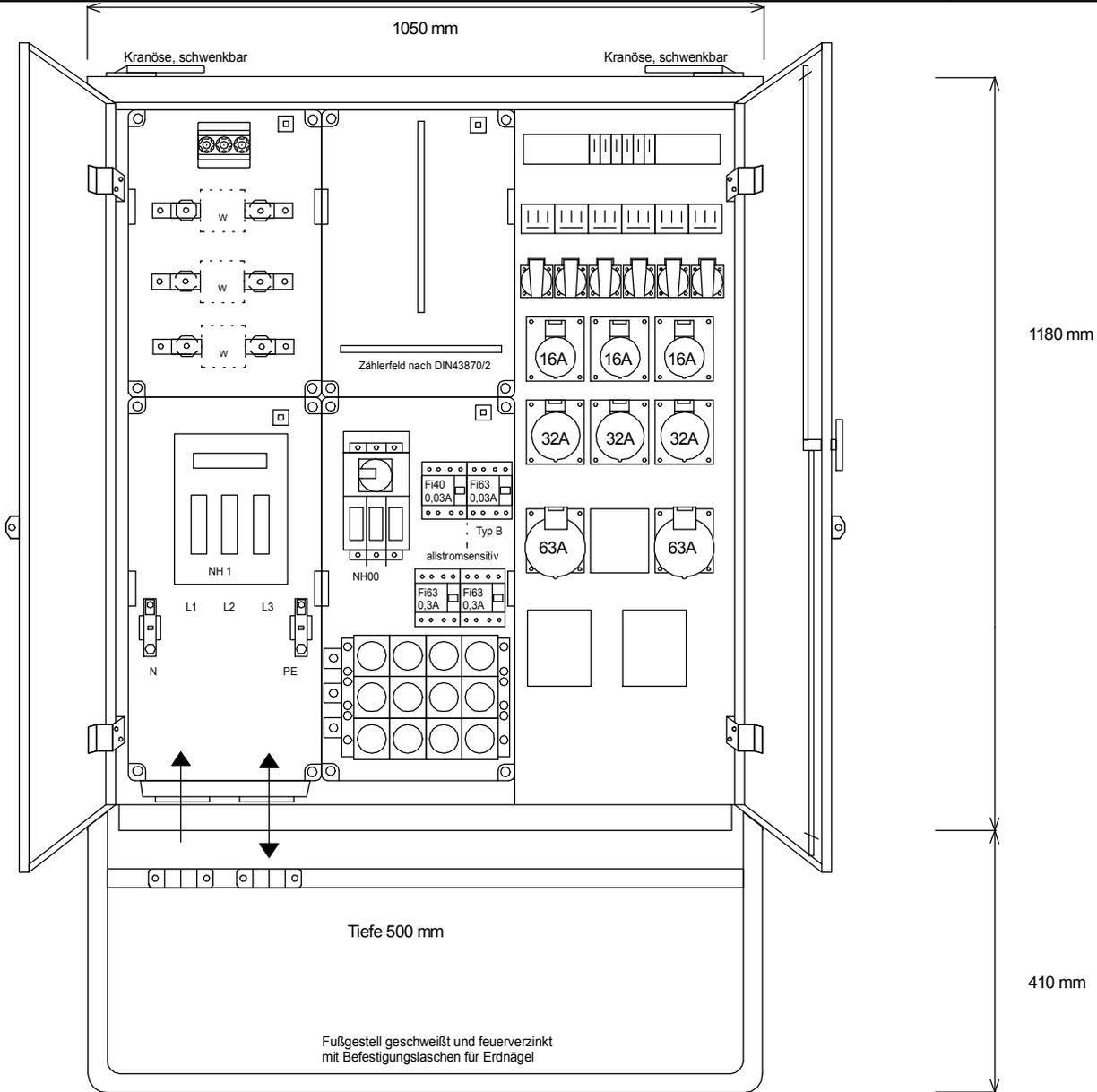
FI-Schalter Typ A sind nicht für den Betrieb Frequenzumrichter gesteuerter Betriebsmittel geeignet!
